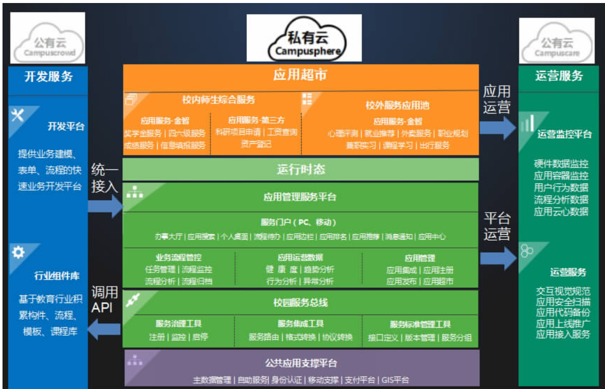
图2 智慧校园技术架构图
